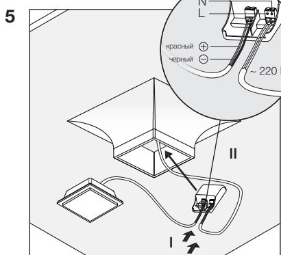
Подключите световой модуль (поз. 2) к блоку питания (поз. 3). Блок питания к электросети (см. схему подключения), а затем установите его за гипсокартонный потолок.
