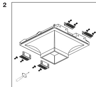
Отрегулируйте крепежный элемент (поз. 4) в зависимости от толщины потолка.
