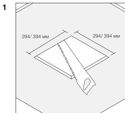
Сделайте отверстие в гипсокартонном потолке (для моделей С50/С85 200x200 - 394 мм, для моделей С50/С85 100x100 - 294 мм).
