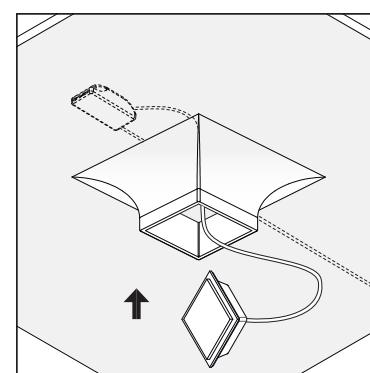
Устанавливать световой модуль в корпус следует, предварительно повернув его под 90° от рабочего положения.
